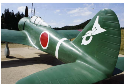
垂直尾翼には当時の貴重な資料を元に部隊のマークを忠実に再現。アンテナ空中線はステンレスワイヤーとガイシで表現、当時は性能が悪く殆ど役に立たなかったそうです。
