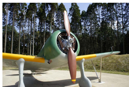
見せ場のプロペラとエンジン、左翼についているのはピトー管、速度を測る機器です。鉄筋を曲げFRPで巻き上げました。
