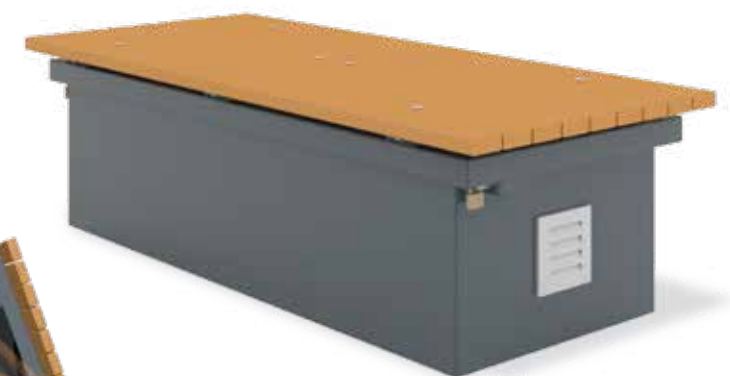
DB-301 サイズ: W1,500×D670×H450mm W1,140×D540×H350mm(収納部寸法) 仕様: 座板 再生木(遮熱・減熱対応品), 収納BOX 鋼材(カチオン電着+粉体塗装仕上)
