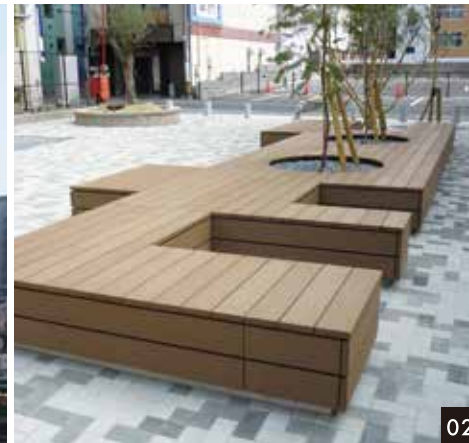
06 ST-D-3002 仕様: 再生木(床板), 鋼材(めっき・塗装)
