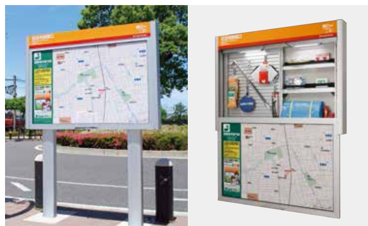
DSI-201 サイズ: W1,502×D151×H2,070mm 収納部サイズ: W1,250×D100×H800mm 仕様: アルミ押出成形材(アルマイト), 上下スライド式(バランス内臓), 表示面SRCメタル印刷, カギ付
