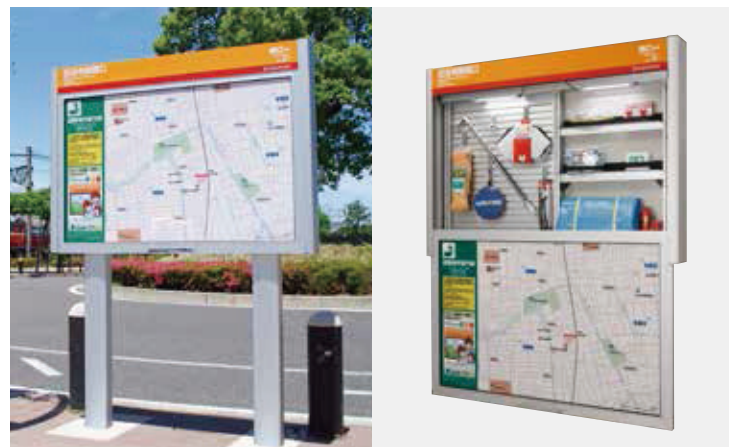
DSI-201 サイズ: W1,502×D151×H2,070mm 収納部サイズ: W1,250×D100×H800mm 仕様: アルミ押出形材(アルマイト), 上下スライド式(パランサー内蔵), 表示面SRCメタル印刷, カギ付
